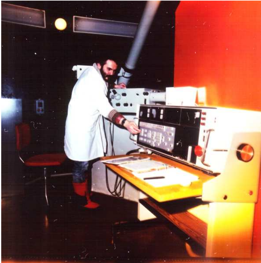
Fig. 12. Предверието на залата на куде-спектрографа (един етаж под телескопа), гледано откъм север (1982 г.) На преден план е дублиращият пулт за управление на телескопа, а тръбата изхождаща от тавана е разположена по продължението на главната ос на телескопа и служи за довеждане на светлината от наблюдавания обект до процена на спектрографа. Дежурен астроном - Любомир Илиев. (архив на проф. Ковачев)
