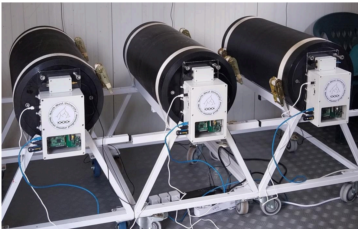
Фиг. 7 Система от три мини неутронни брояча (НАО-Рожен, 2024 г.)
